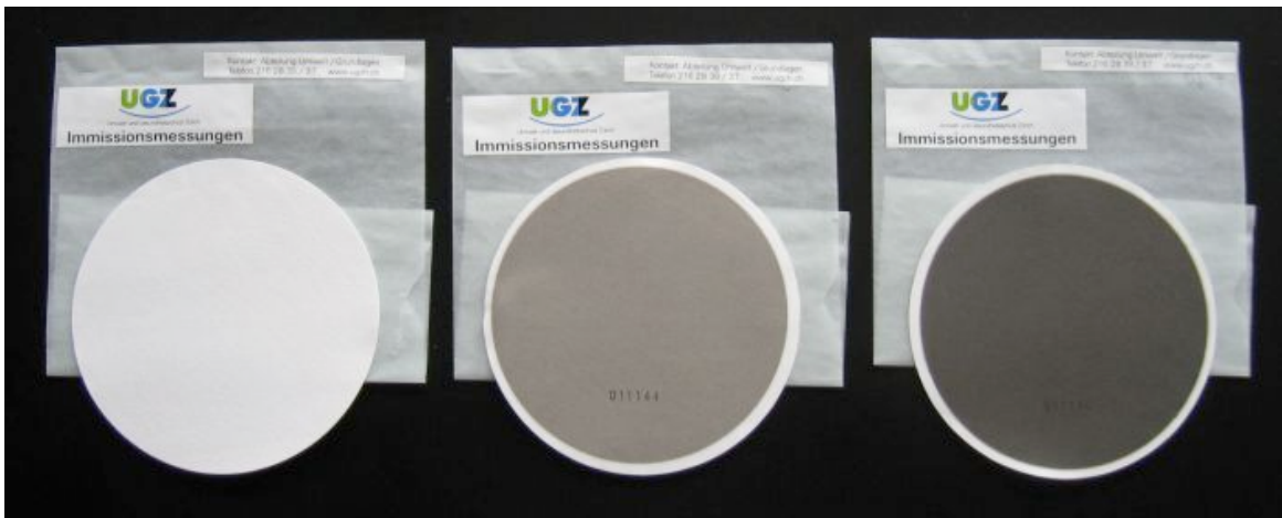
Abbildung 7: PM10-Filter im Vergleich: neuer Filter - sonntags - werktags
